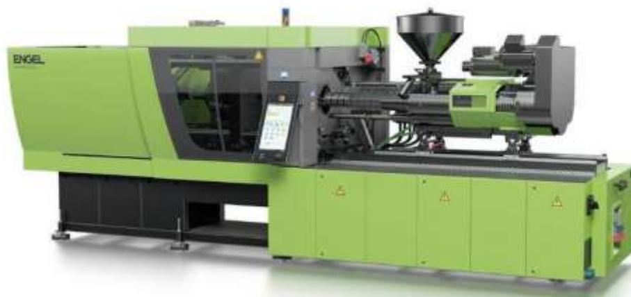
imagen 12. Maquina inyectora de plástico
