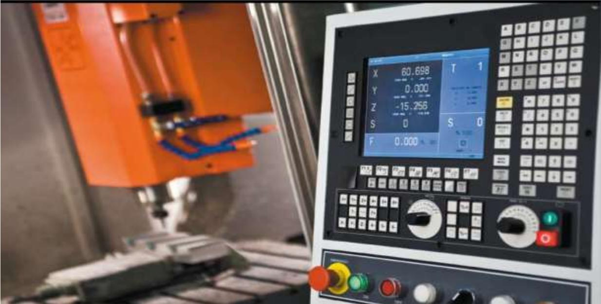
*imagen 19. Panel de control de un centro de maquinado CNC*
