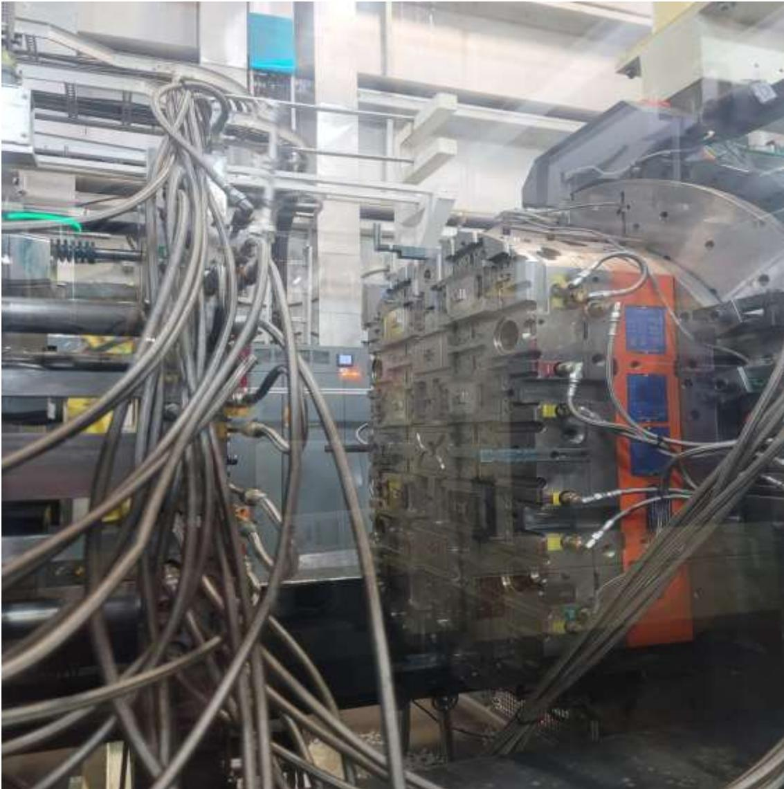
Imagen 36 Molde montado en máquina inyectora
